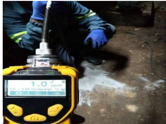
Figura 4.1.3 – Medição expedita de COVs nas sondagens
